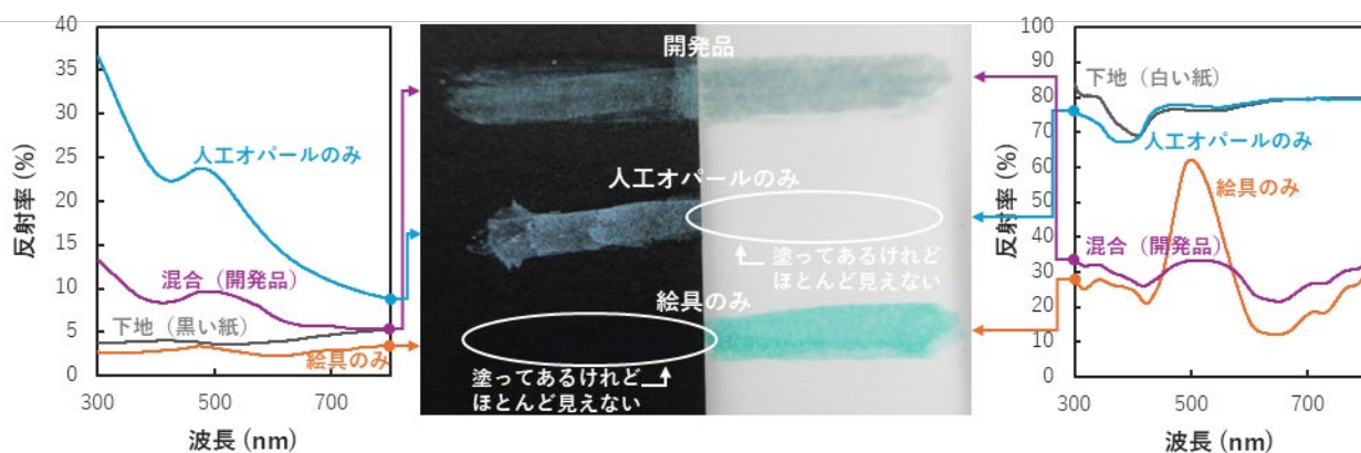
図3 黒い紙と白い紙に緑系の粒子分散液を塗布した外観と分光光度計で測定した反射スペクトル
