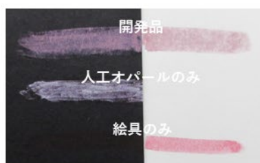
図5 黒い紙と白い紙に赤系の粒子分散液を塗布した外観
