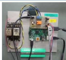
制御盤の裏にマイコンやリレーを設置
