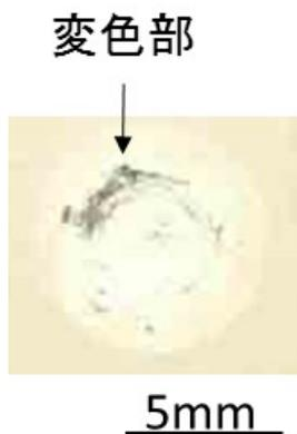
図6 化成処理後のアルミニウム合金板表面に生じた変色部
