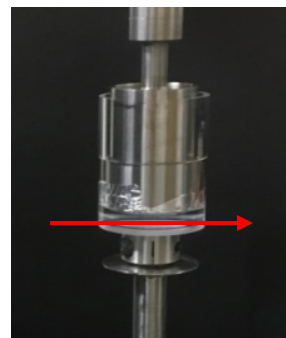
図 6 \tau_r を測定する際に用いたクエット。上部は Ti 製ボブ, 自作したガラス製の透明カップである。 \tau_r は, ボブとカップの隙間部のレーザ光の散乱量で求めた。
