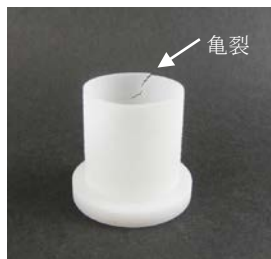
図 9. ABS ライク 0.25mm 厚 フィレットあり
