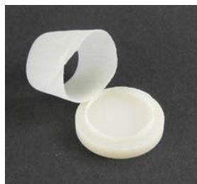
図 8. エラストマーライク 150 0.25mm 厚フィレットあり
