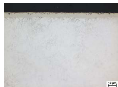
図5 疲労試験後の引張側表面近傍の金属組織 (S45C \gamma' 材 最大応力 950MPa 未破断)
