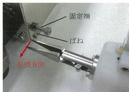
図4. 引張ばねを用いた性能評価における実験装置
