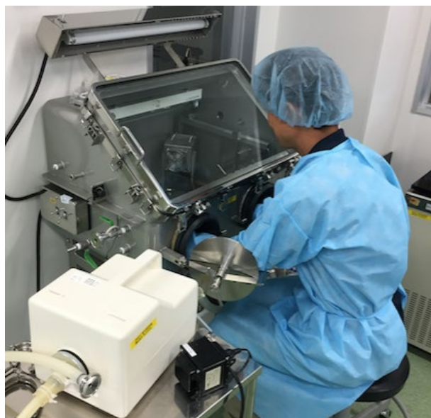
図2. グローブボックスを用いた抗ウイルス性能評価試験
