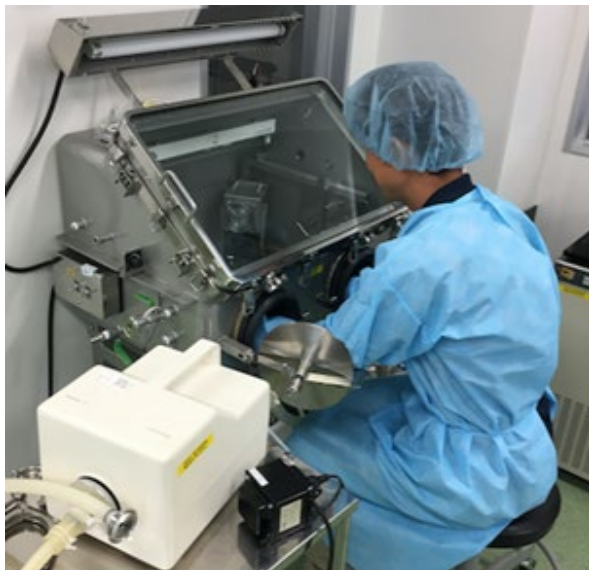
図 3. ウイルス噴霧試験の様子
