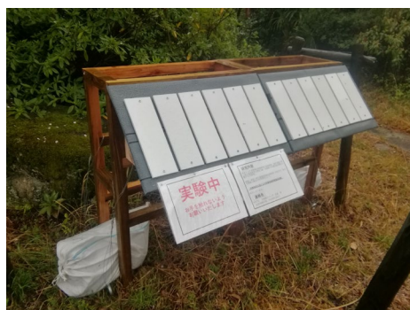
図 5. 光触媒加工品による実環境における防藻性能評価試験
