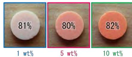
図 3 Eu 賦活 CaAlSiN<sub>3</sub> 粒子分散 MgO バルク体の外観
