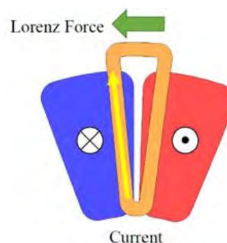
図2. 駆動力の生成原理
