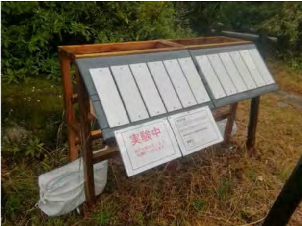
図 1. 防藻性能実証試験の実際
