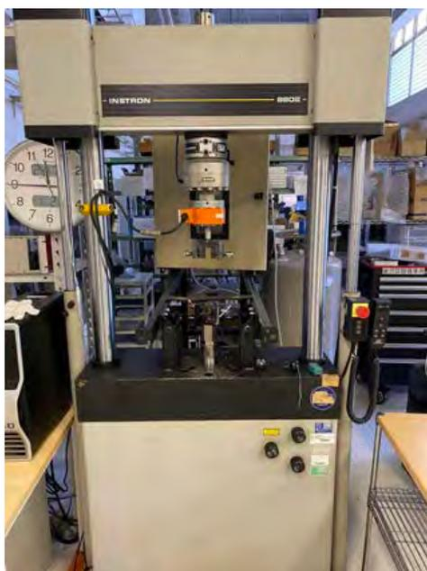
図 1 疲労試験機 (インストロン製 8802 型)
