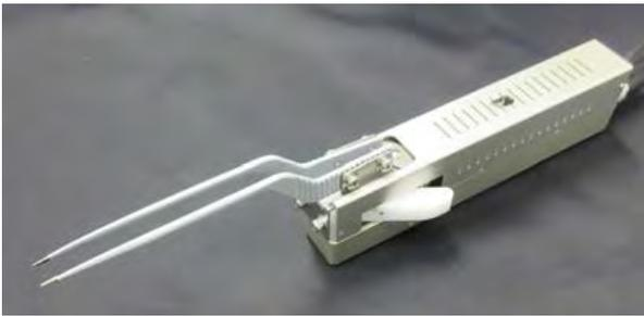
図6 ハプティック鉗子デバイス試作機
