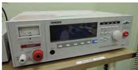
図 1. 耐電圧試験機
