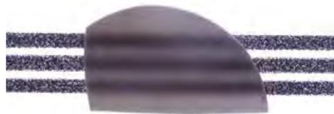
図 2 MgO バルク体の外観 (粗大 MgO 70wt%)
