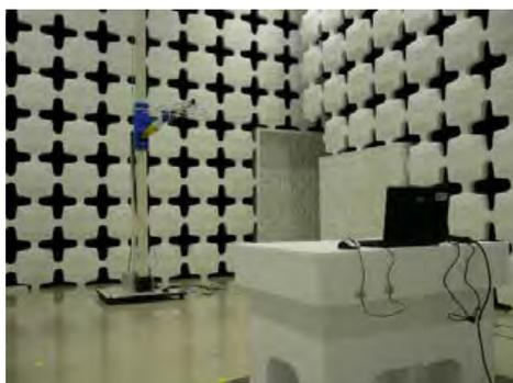
図 1 3m 法電波暗室における放射エミッション測定
