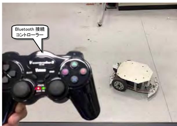
図2. Bluetooth接続による手動操作
