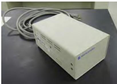
図 2. 試験用サンプル (絶縁トランス)
