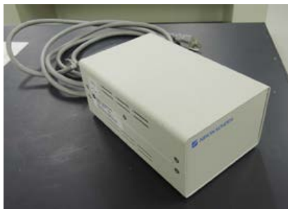
図 2. 試験用サンプル（絶縁トランス）
