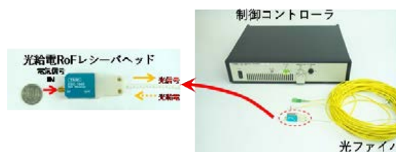
図 2 開発した光給電 RoF レシーバ
