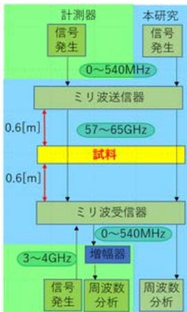
図4 ミリ波帯の構成例1及び構成例2の測定系
