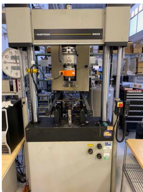
図 1 疲労試験機（インストロン製 8802 型）
