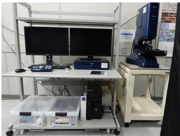
図 1. ハイブリッドレーザー顕微鏡の装置外観
