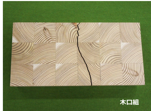
図6 破壊した木口組の試験体
