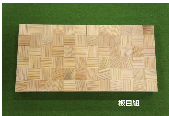
図5 破壊(中央部)した板目組の試験体
