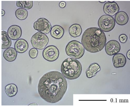
図 15 浸液透光法で観察した原料に用いた市販 Al 2 O 3 顆粒の内部構造。
