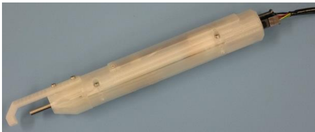
図2 試作したペン型組織剛性計測装置
