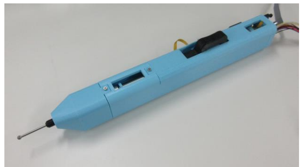
図 1. 2 自由度ドリル試作機
