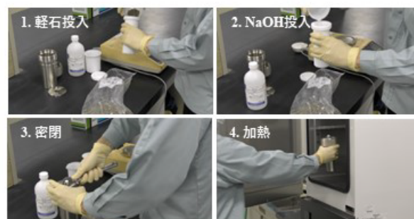
図 1 水熱処理によるゼオライト軽石の作製手順
