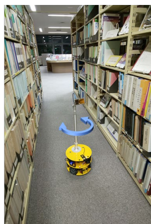
図 13 測定点 B における電波強度測定
