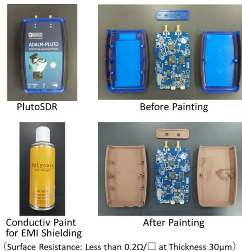
図 8 電磁シールド塗料による SDR の電磁ノイズ対策
