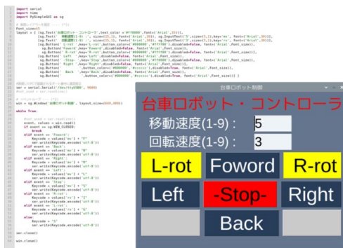
図 6 Python によるロボット・コントロール GUI
