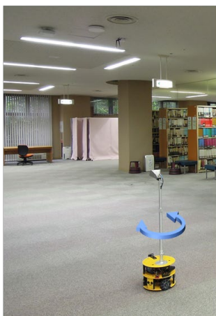
図 12 測定点 A における電波強度測定
