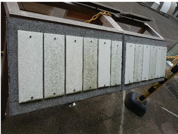
図2：光触媒による防藻性能実証試験結果
