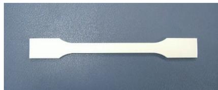
図 1 ダンベル形試験片
