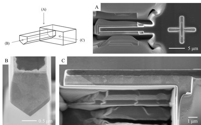
FIB加工によるマイクロカンチレバーの作製
