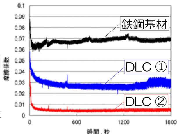
DLCとオレイン酸潤滑の組み合わせによる超低摩擦化
