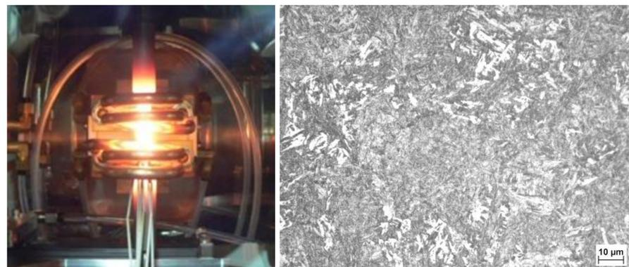
熱処理再現試験装置（左図）を用いてオーステンパー処理したSK85鋼の金属組織（右図）
