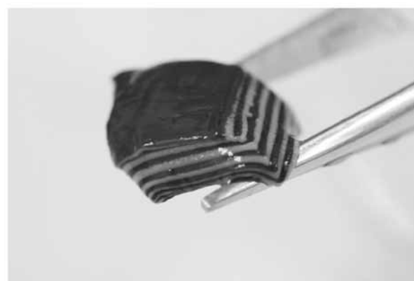
図 7. 多色積層ゲル構造
