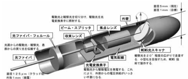
図3 外部からの電気配線を必要としないMEMS光スキャナを利用した光ファイバ内視鏡の概念図。
