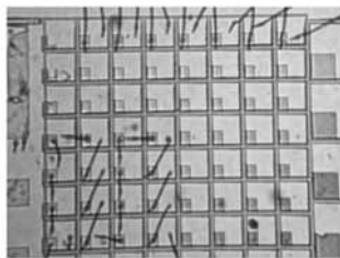
図1 SOIシリコン基板上にPIN層をエピ成長して製作したフォトダイオードアレイ。
