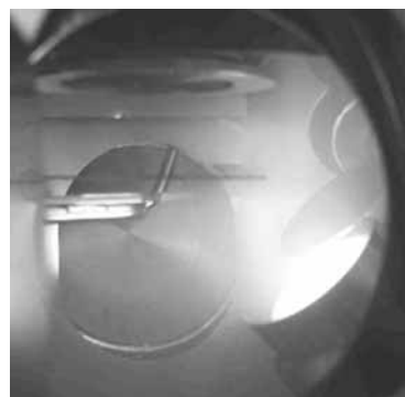
図 2 パルススパッタリング装置
