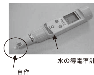
図5 汚れ判別センサー
