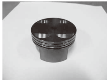
図 6 DLC コーティングアルミピストン
