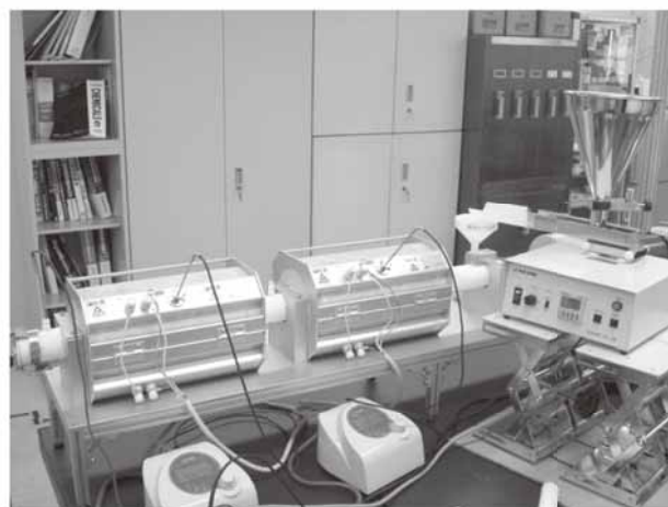
Figure 3. 設計開発した連続式糖化装置の概要
