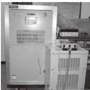
図 11 60 [kW] 直流電力調整装置の外観
