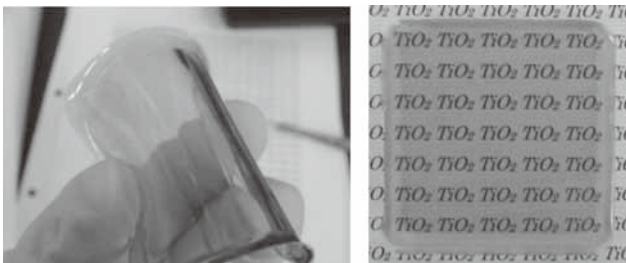
図4. TiO 2 -PDMS-ビニルシラン複合エラストマー
