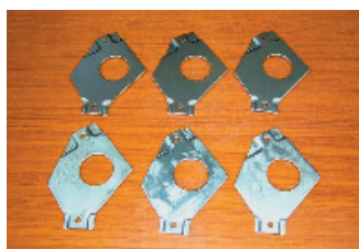
図1. 亜鉛めっき膨れ不良
