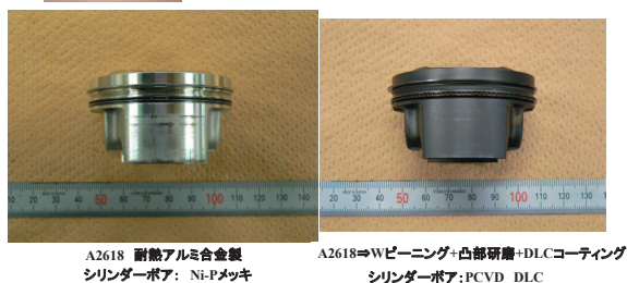
図 6. エンジン試験後の摩耗状況
