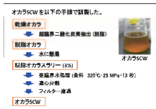
図9 オカラ亜臨界水処理物（SCW）の調整方法
