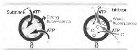
図 4. マイクロ流路固定化ベシクルにおけるローダミン 123 の競争的輸送の観測原理
