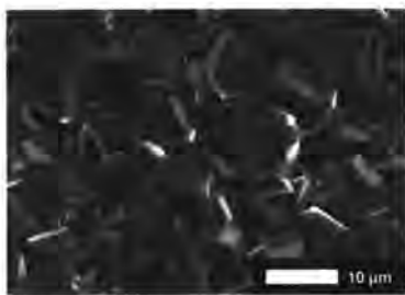
図 1. BDD 電極の SEM 像
