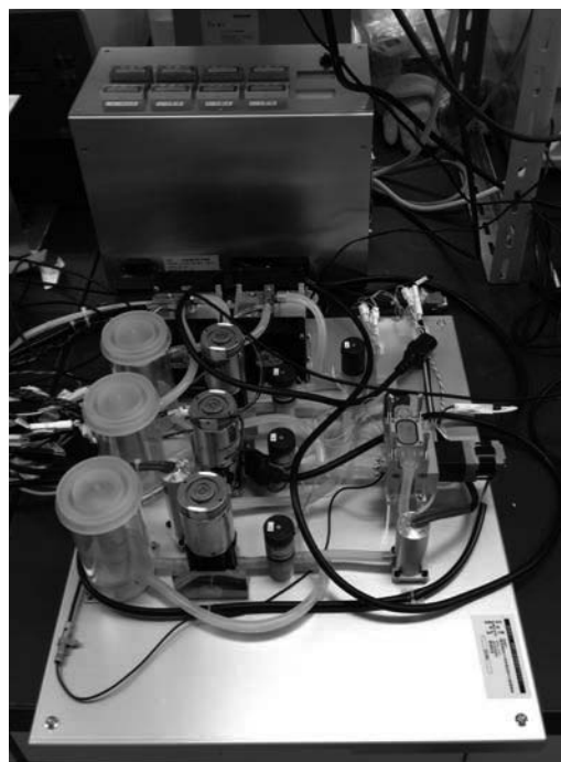
図 3 3 温度型超高速 PCR 装置原理検討機。通常 PCR を行う温度変化プロトコルを高速で行う事が出来るようになった。
