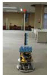
図2 SDRとROS対応の台車型移動ロボットによる移動式の電波計測システム
