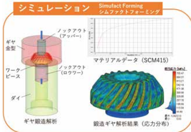
図3 ギヤ鍛造の弾塑性解析シミュレーション
