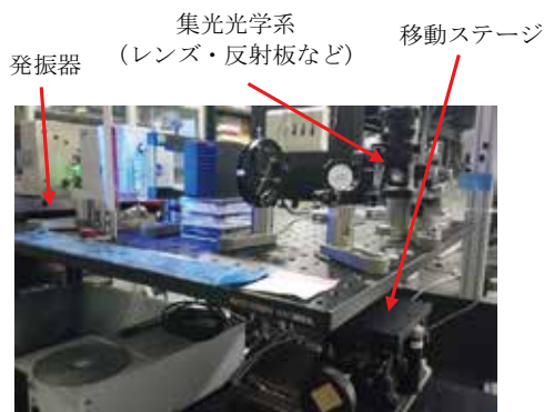
試作した極短パルス紫外レーザー概要
