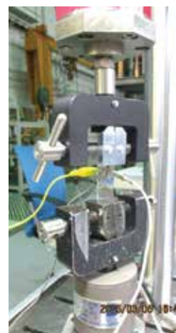
図3: 疲労試験の様子
