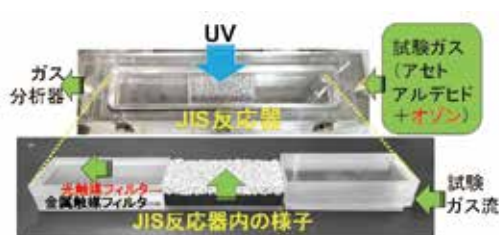
図1：アセトアルデヒド分解試験の概略図
