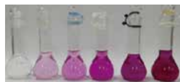
図3：ジフェニルカルバジド吸光度法による、6価クロムの分析
