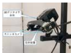
図2：3Dデジタイザ構造
