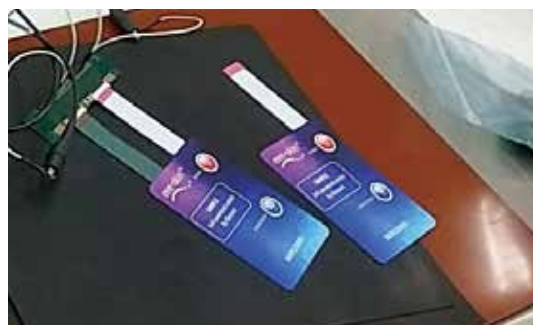
図2：「自己発電」するスイッチ(試作品)
