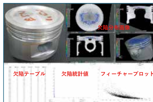
図3：アルミダイカスト部品の解析結果
