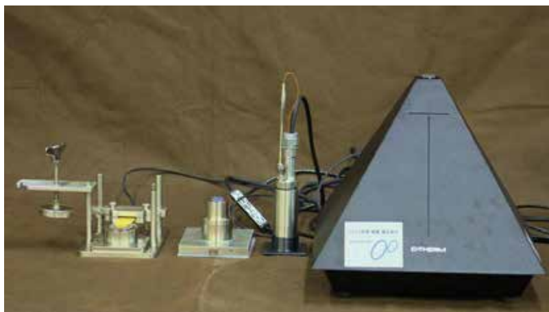
図1：熱伝導率測定装置とセンサー(左から TPSセンサー、mTPSセンサー、液体専用ユニット)
