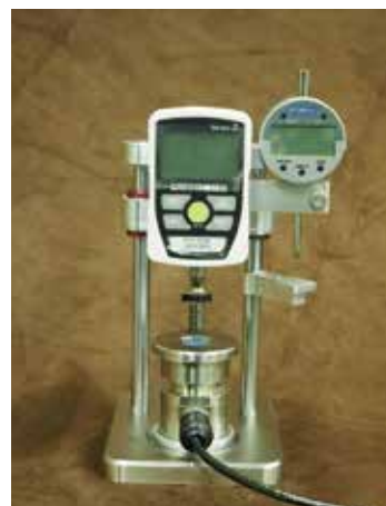
図2：mTPSセンサーに粉体測定用の圧縮試験アクセサリと粉体試料ホルダー
