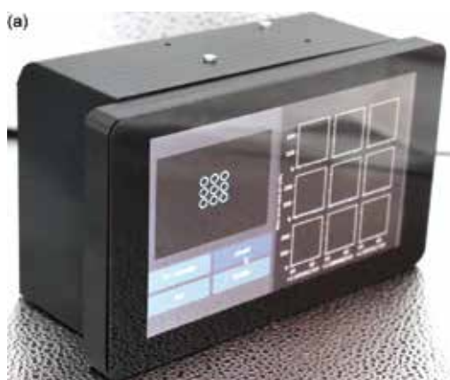
図：(a) 細胞センサチップの応答信号を検出可能な小型蛍光イメージャ (b) 原始的な膜構成要素と考えられるモノグリセリドと脂肪酸からなる膜のイオン透過機構の模式図
