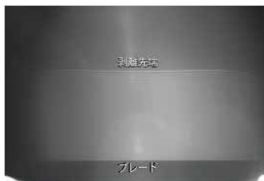
図2：赤外線カメラを用いた接合ウエハ上部からの剥離観察
