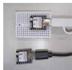
図2 小型マイコンによるThreadの接続実験
