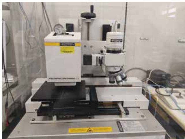
図4：(株) フィッシャー・インストルメンツ HM-2000 (装置写真)
