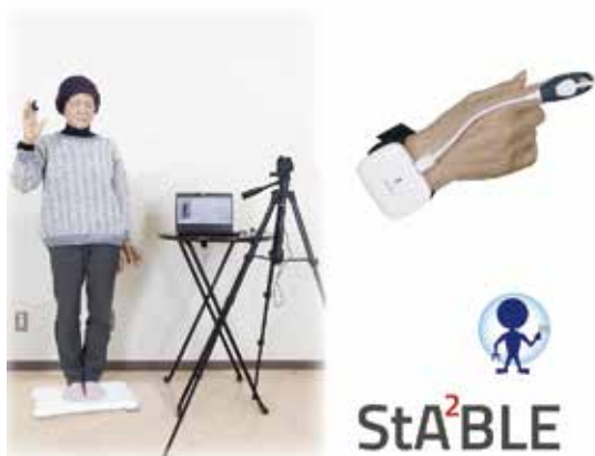
図1：立位機能検査装置
