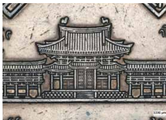
図4：タイル合成機能を使い撮影した10円玉 〔 大きさ：24191×18162ピクセル 高倍率レンズ撮影画像100枚をタイル合成 〕
