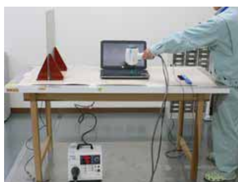
図2：静電気放電試験
