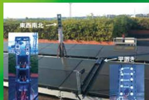
図4：ペロブスカイト太陽電池の屋外暴露試験の様子
