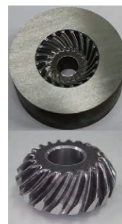
図5：鍛造解析より弾性変形を考慮したギヤ金型（5軸制御マシニングセンタで加工）と鍛造ギヤ（ギヤ金型で鍛造加工）
