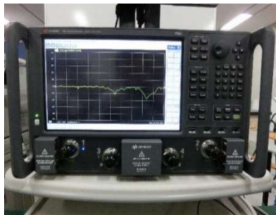
マイクロ波ネットワークアナライザ ※目的積立金により整備
