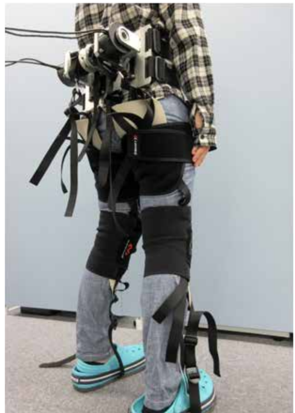
図9 下肢筋機能支援ロボット
