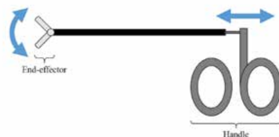
図1. 従来の腹腔鏡手術用鉗子の構造の概略図
