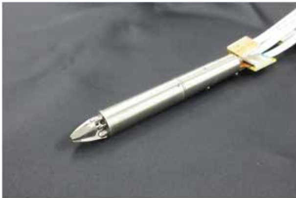
図7 多自由度ハプティック鉗子デバイス
