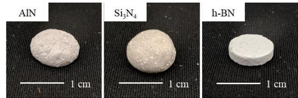
図4 500 °C で焼成した各種高熱伝導粒子分散ガラスの外観。
