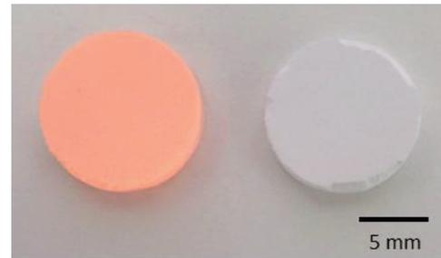
図 8 常温緻密化後(左)と高温焼成後(右)の外観 (UV-LED 照射)
