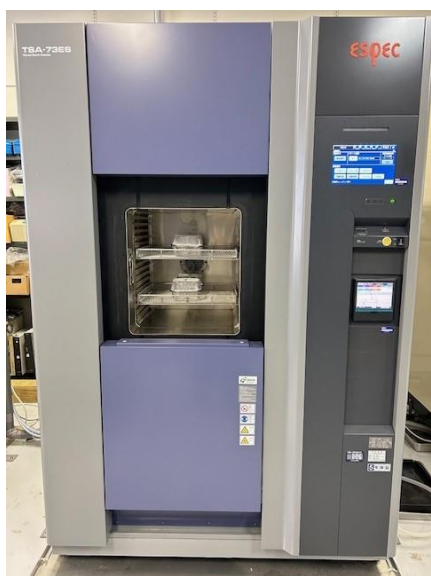
図2 冷熱衝撃試験機 エスパック製TSA-73ES
