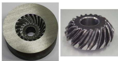
鍛造解析より弾性変形を考慮したギヤ金型（5軸制御マシニングセンタで加工）と鍛造ギヤ（ギヤ金型で鍛造加工）
