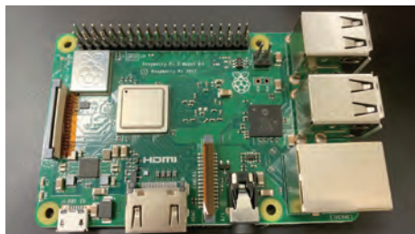
安価に IoT 導入が可能となる Raspberry Pi
