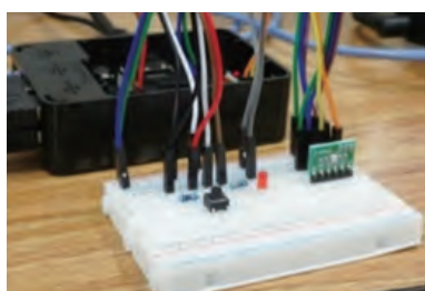
ブレッドボードを用いた簡便な配線
