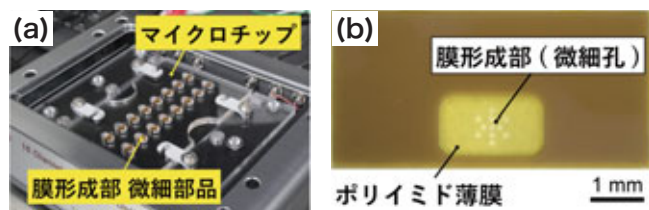
図 a 開発した膜タンパク質機能計測システム 図 b 細胞膜形成部部品。中央に複数ある微細孔に細胞膜を作製
