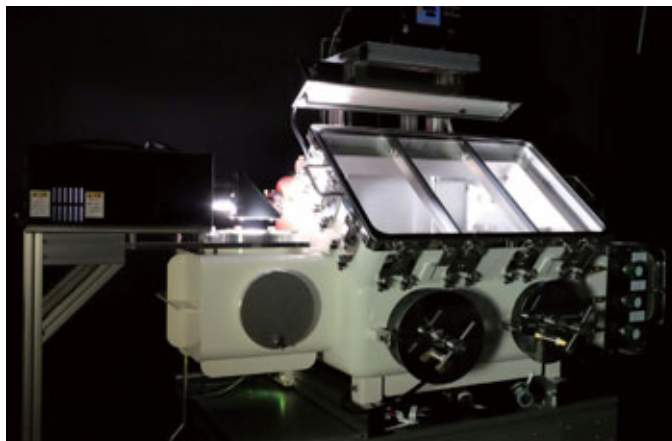
未封止の PVK 太陽電池を評価する環境制御試験槽 ※本装置は NEDO の研究助成金により作製したものです。
