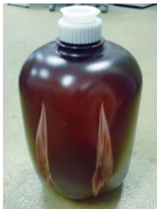
図1 き裂が発生した初期の試作品
