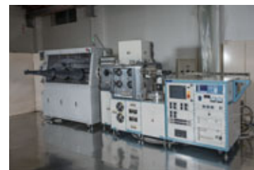
(株)エイエルエステクノロジーの有機EL研究用真空蒸着装置(山形大学と共同開発)
