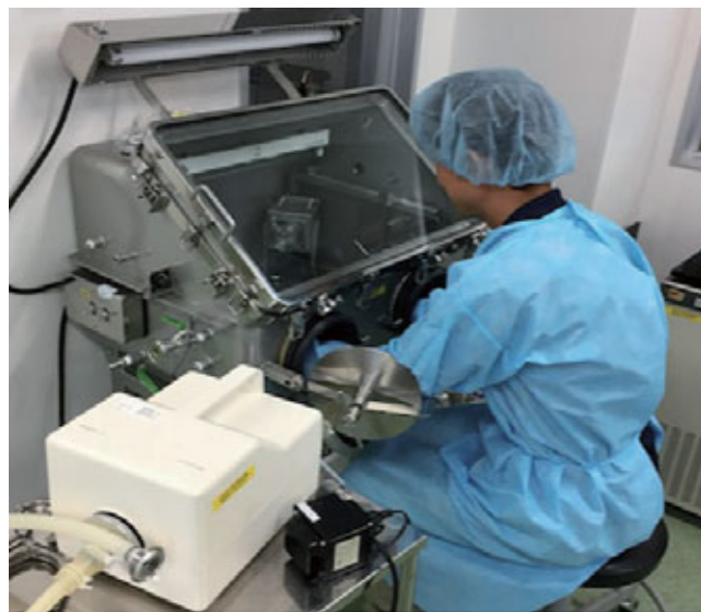
図1 グローブボックスを用いたウイルス噴霧試験の様子
