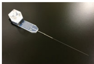
NANOBIIC保有機器設備の共用化 機器利用の中小企業支援成果例 （痛みの少ない極細針により底流速制御の点滴を行う点滴デバイス）
