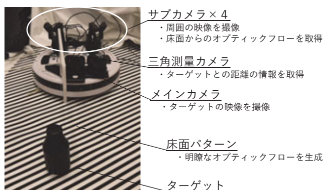
図2 小型ロボットによる遠隔操作可能な重機のモデル
