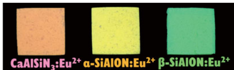
図 1 常温緻密化プロセスで作製した窒化物蛍光体粒子分散 MgO 緻密体の外観
