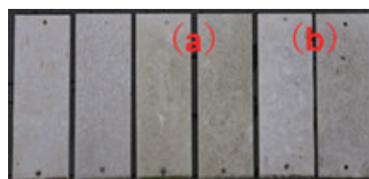
図 防藻実証試験例(海老名本部に設置した基材) 藻類と思われる緑色の汚れが顕微鏡処理試験片(a) では認められるが光触媒加工(b)では認められない。
