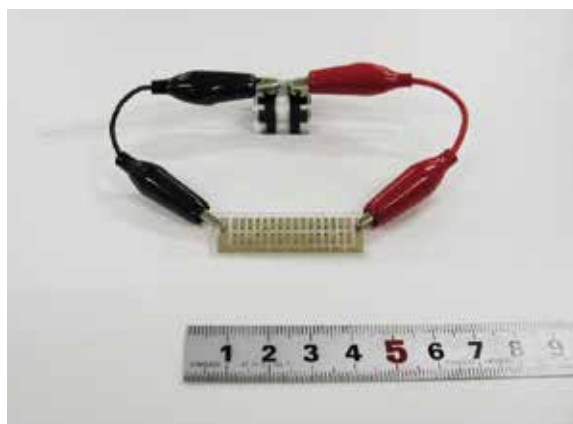
マイクロ燃料電池とEOポンプの接続の様子
