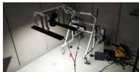
床面ひび割れ検知ロボットのLED照明化
