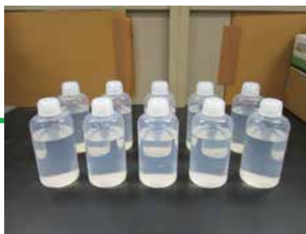
図 1 作製した水道水標準物質 (六価クロム濃度：0.051mg/L)
