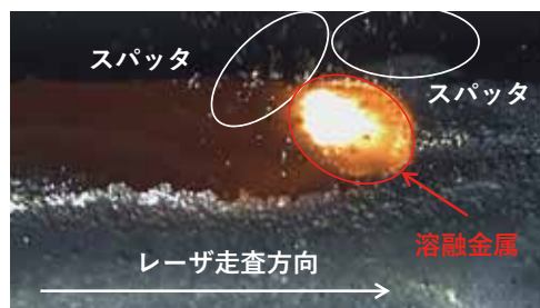
高速度カメラによる溶融金属の観察
