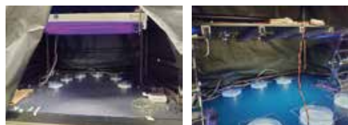
図. 蛍光ランプとUV-LEDによる抗菌試験例
