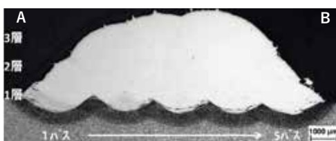
高速度工具鋼粉末による堆積層の外観写真と断面マクロ組織写真
