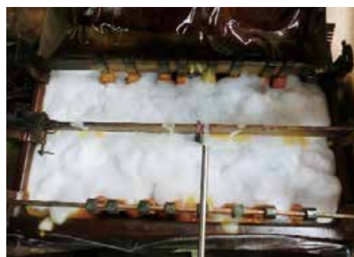
泡沫で表面を覆った時の電解めっき
