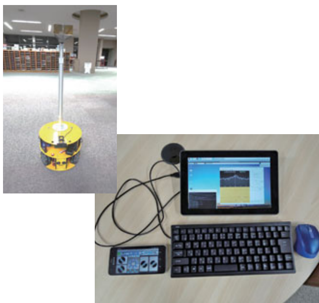
図3 移動式の5G(サブ6)対応電波測定システム
