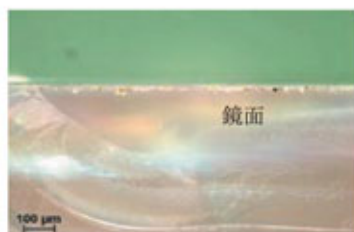
図1 エタノールによるアクリル板の環境応力割れ
