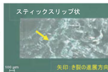
図2A 浸漬無しのアクリル板の引張破断面
