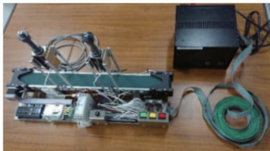
自動プレス加工ラインのミニチュア装置 (左) と3D仮想モデル (右)
