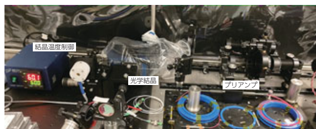
紫外化のための非線形光学結晶および温度制御
