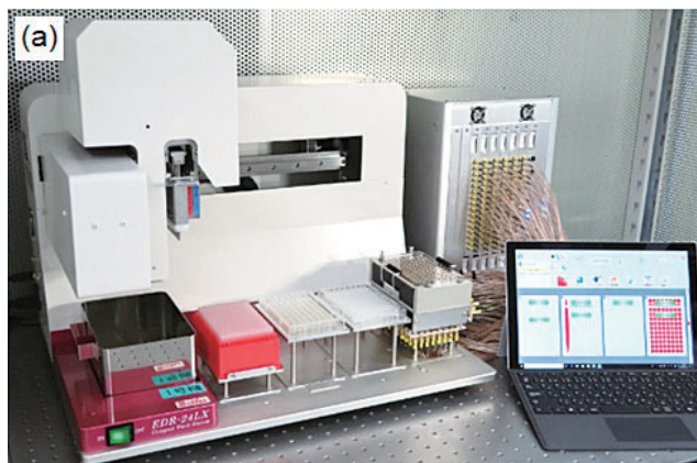
(a) 人工細胞膜チップを搭載する薬剤候補化合物の評価システム。
