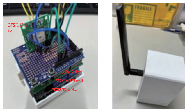
図1 開発したLoRaWANのエンドノードの内部と外観
