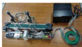
PLCプログラミングの実習機材 (H30年度 経産省補助で作成)
