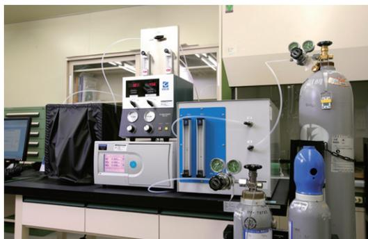
窒素酸化物の除去性能試験装置
