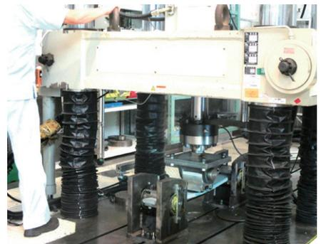
構造材料の曲げ試験の様子
