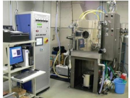
熱処理再現試験装置
