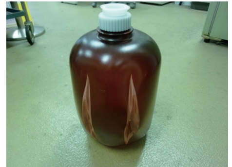
図1 き裂が発生した初期の試作品
