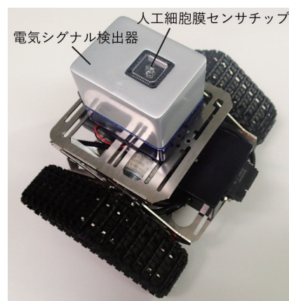
図3▶ 開発中の匂いセンサロボット (NEDO「次世代人工知能・ロボット 中核技術開発」委託事業成果)
