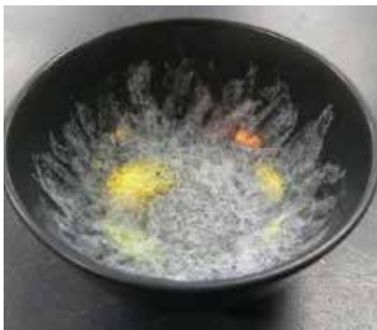
図2: 主に正反射光による発色。視点の角度によって色が異なる。
