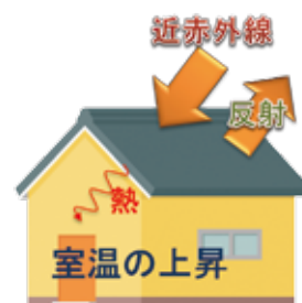
図2：近赤外線反射による室温上昇の抑制
